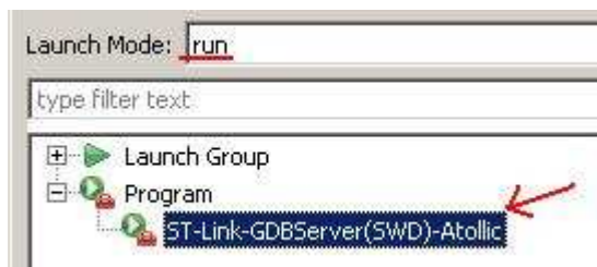
Рис. 15 - Добавление конфигурации сервера в группу запуска на примере программы от Atollic
