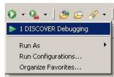
Рис. 17 - Место запуска отладки GDB
