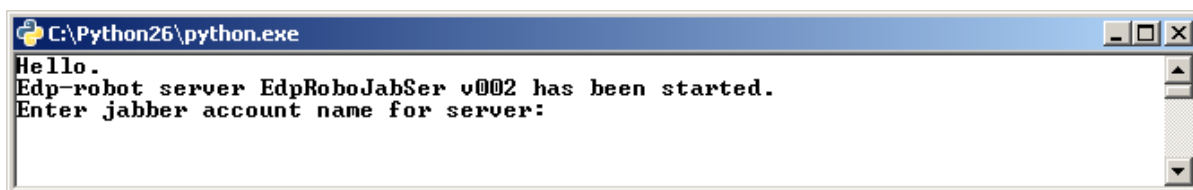
Рис. 8. Проверка правильности установленного ПО для серверного компьютера
