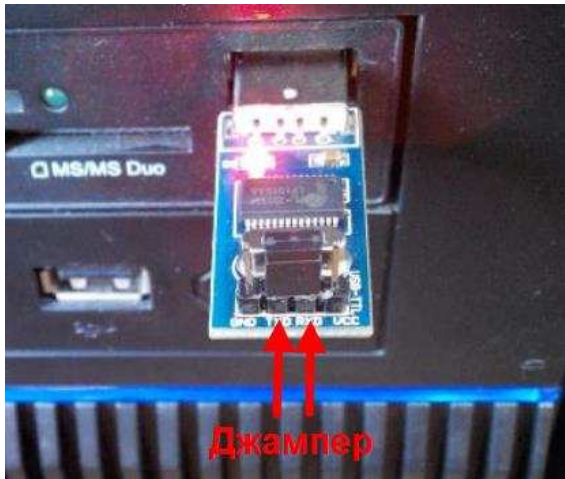
Рис. 4 Подключение преобразователя PL2303 к компьютеру
