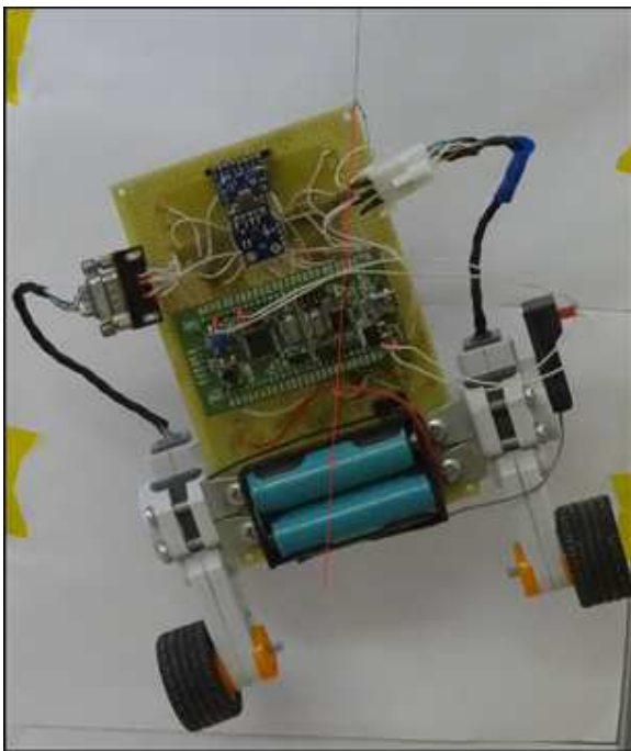
Рис. 33. Опыт по определению расстояния от центра масс робота до точки подвеса
