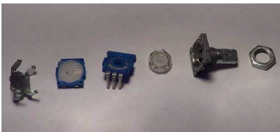
Рис. 3. Составные части энкодера (последовательно)
