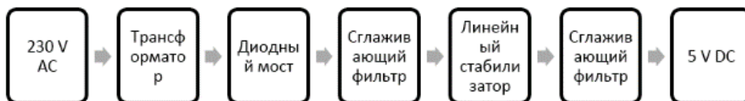
Рис. 3. Блок-схема источника питания
